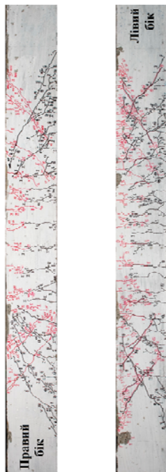
Рис. 1. Утворення нормальних і похилих перехресних тріщин на бічних поверхнях балки (серія 2, дослід № 17) з поділом її на окремі блоки перед руйнуванням при малоцикловому знакозмінному навантаженні при \eta = \pm 0,65F_u
