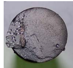
Рис. 11. Зломи зварних модельних зразків № 3 (а) та № 4 (б)
