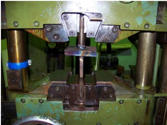
Рис. 5. Зразок зварного з'єднання у випробувальній машині ЦДМ-10пу під час випробовувань на втому
