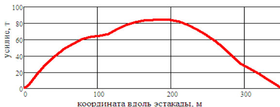
Рис. 8. Линия влияния усилия, передающегося посредством тросов на устои № 0 от действия центробежной силы 100 т
