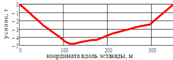
Рис. 9. Линия влияния усилия, передающегося посредством тросов на устои № 0 от действия крутящего момента 100 т·м
