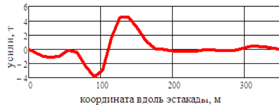
Рис. 10. Линия влияния усилия, передающегося посредством тросов на устои № 0 от действия вертикальной силы 100 т
