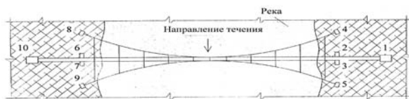
Рис. 1. Схема расположения опор моста
