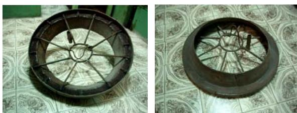
Рис. 1. Первинний варіант армування кришки люка (зразок для випробувань)
