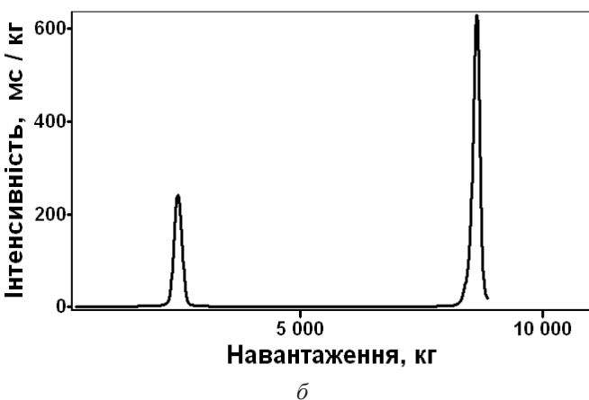
Рис. 3. Сигнали зважування та інтенсивності двохосного автомобіля: а – сигнали вхідний та фільтрації, б – сигнал інтенсивності
