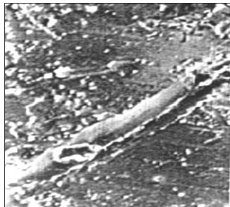
Рис. 5. Поверхня тертя матеріалу P6M5Ф3 + 5%CaF 2 після триботехнічних випробувань із вихідними параметрами R_a = 0,225–1,007 мкм, \times 150
