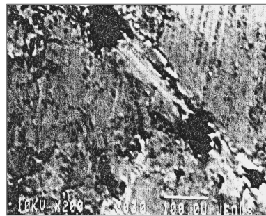
Рис. 5. Мікрорельєф поверхні тертя матеріалу P6M5Ф3 + 5 %CaF 2 після триботехнічних випробувань при навантаженні 9 МПа (зйомка треку тертя в режимі фазового контрасту), × 200
