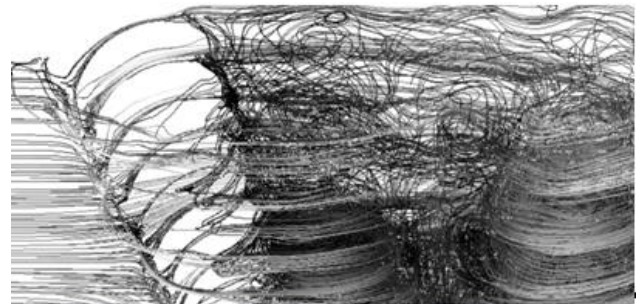
Рис. 3. Траєкторії руху частинок потоку при омиванні поперечним потоком гвинтоподібної труби
