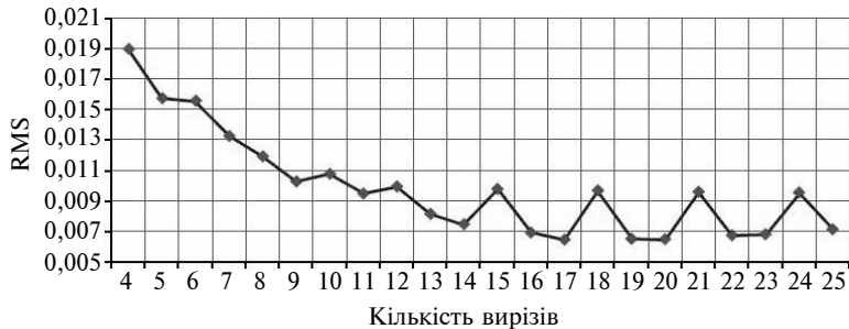
Рис. 6. Залежність деформації дзеркала від кількості вирізів у кожному з кільцевої полегшення
