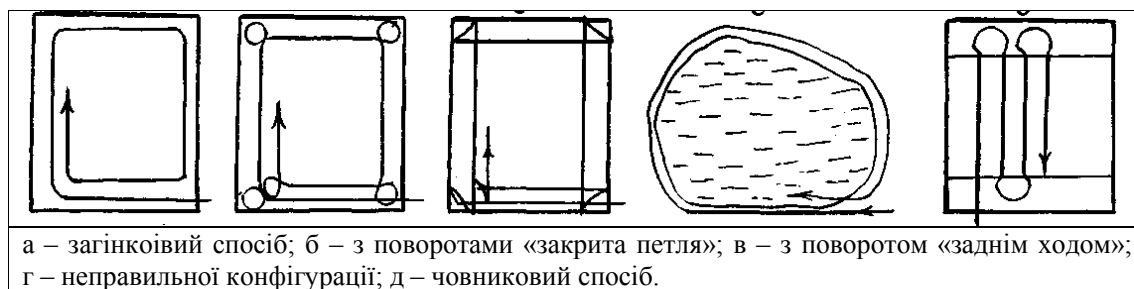
Рис.2. Узгодження технологічних операцій та схеми руху комбайна.
