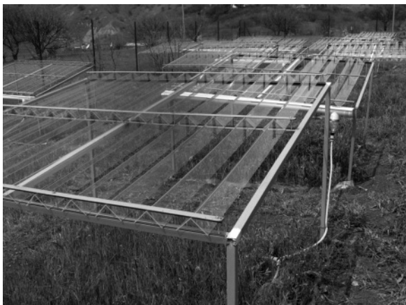
Рис. 2. Конструкції для регулювання кількості, збирання та перерозподілу опадів
