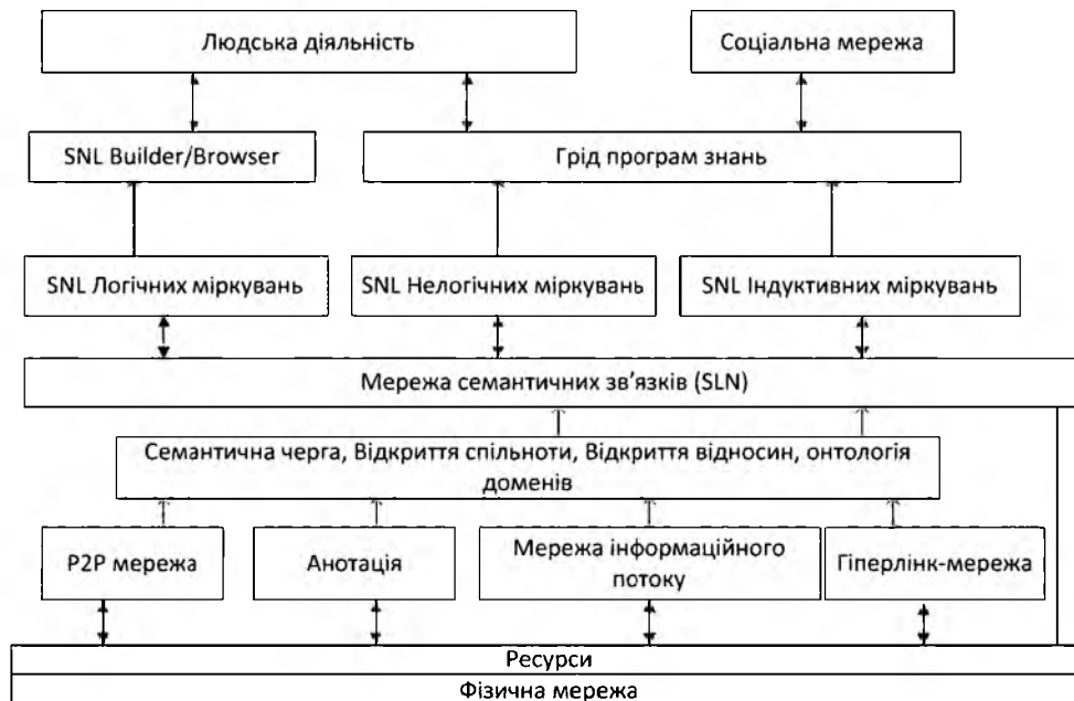
Рис. 4. Загальна архітектура автономної SLN (Виділена пунктиром частина рисунка показує ядро автономної SLN)
