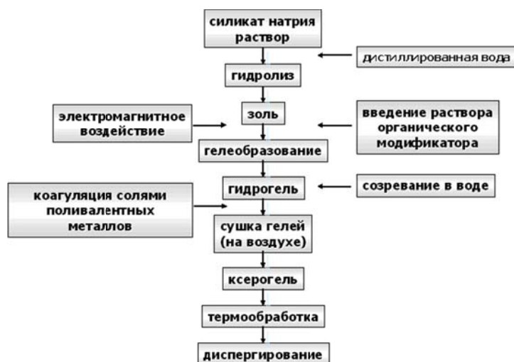
Рис. 1. Схема золь–гель-процесса получения органосиликатного нанокompозита.
