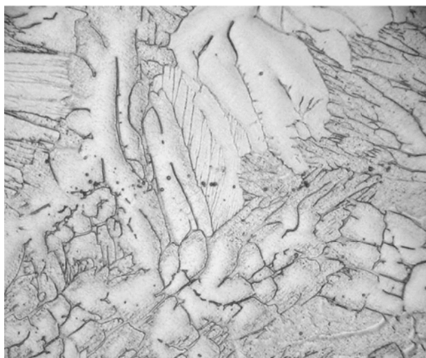
Рис. 5. Микроструктура зоны соединения алюминид титана с многослойной Ti/Al наноструктурированной промежуточной прослойкой после отжига. \times 500 .
