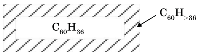
Рис. 8. Топохимическая модель сжимающейся оболочки, характерная для гидрирования фуллерита после достижения концентрации C_{60}H_{36} .
