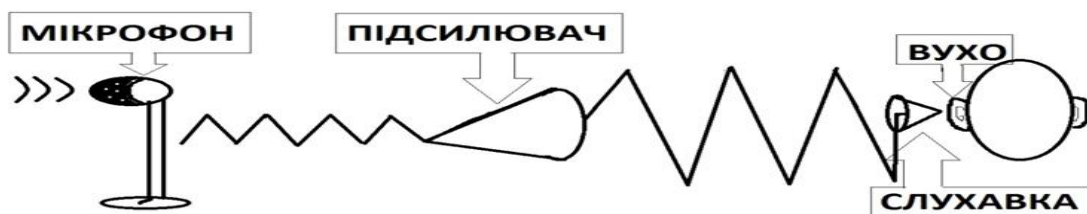
Мал.1. Схема проходження звуку через слуховий апарат.
