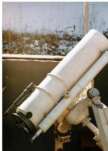
Телескоп системи Річі-Кретьєна D = 400\text{мм}
