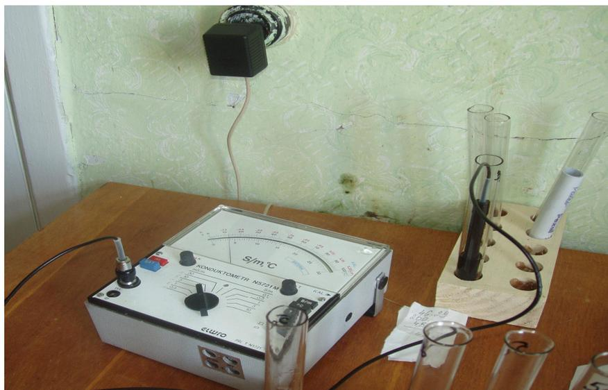
**Рис.1. Кондуктометр №5721М (Польща)**
