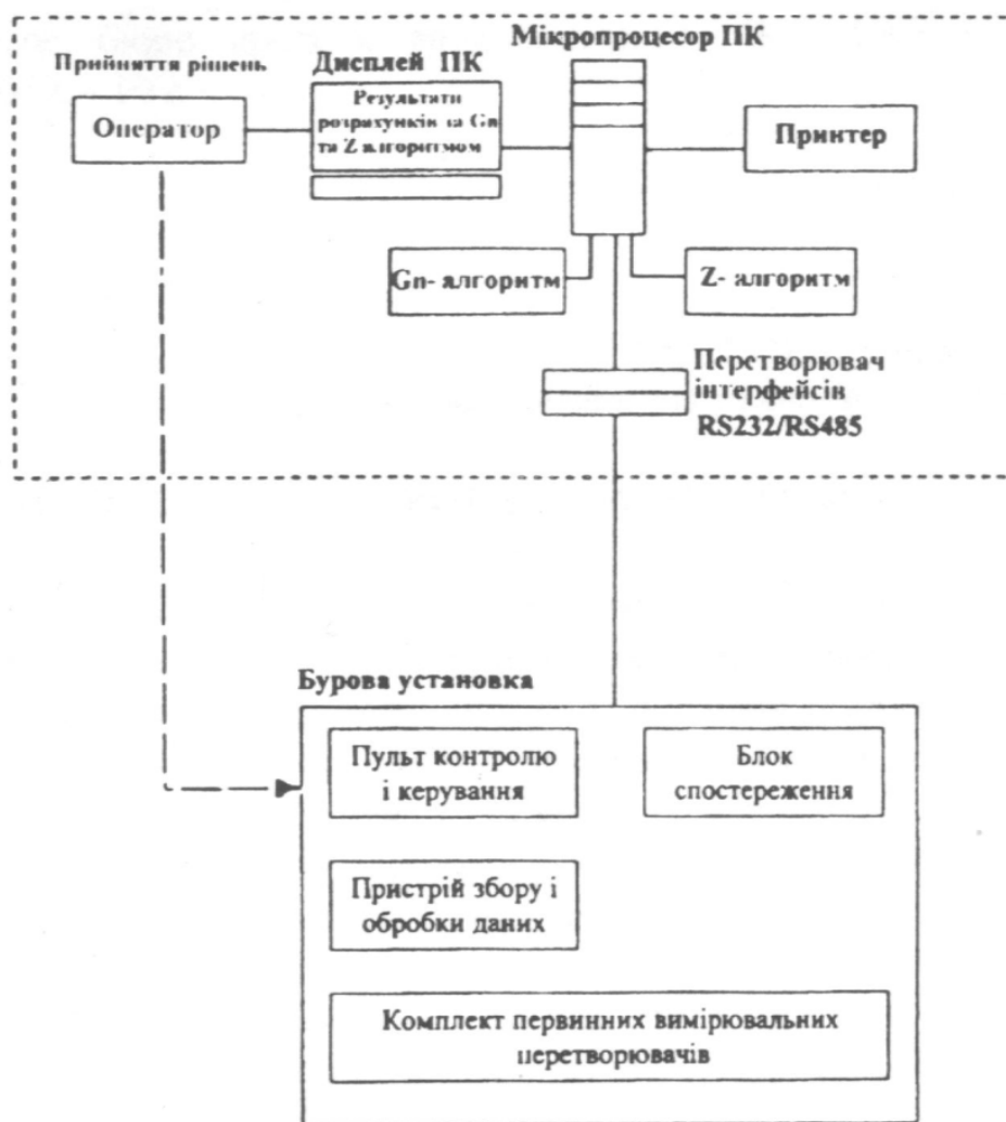
Рисунок 2 – Функціональна схема пристрою визначення зміни меж пластів
