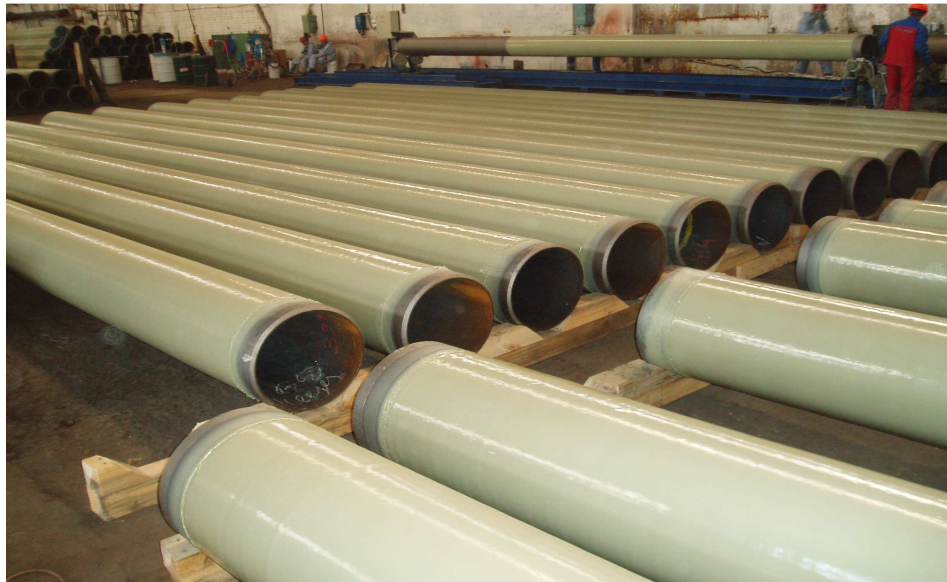
Рисунок 2 – Покриття труб поліуретаном «Байсит» у заводських умовах
