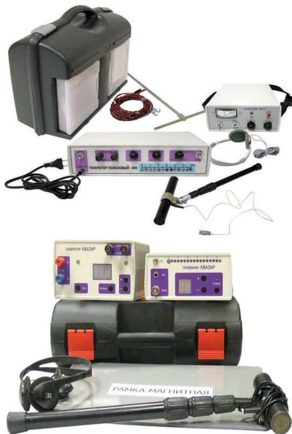
а) – трасошукач «ИКкт-300»; б) – шукач пошкоджень «Квазар»
