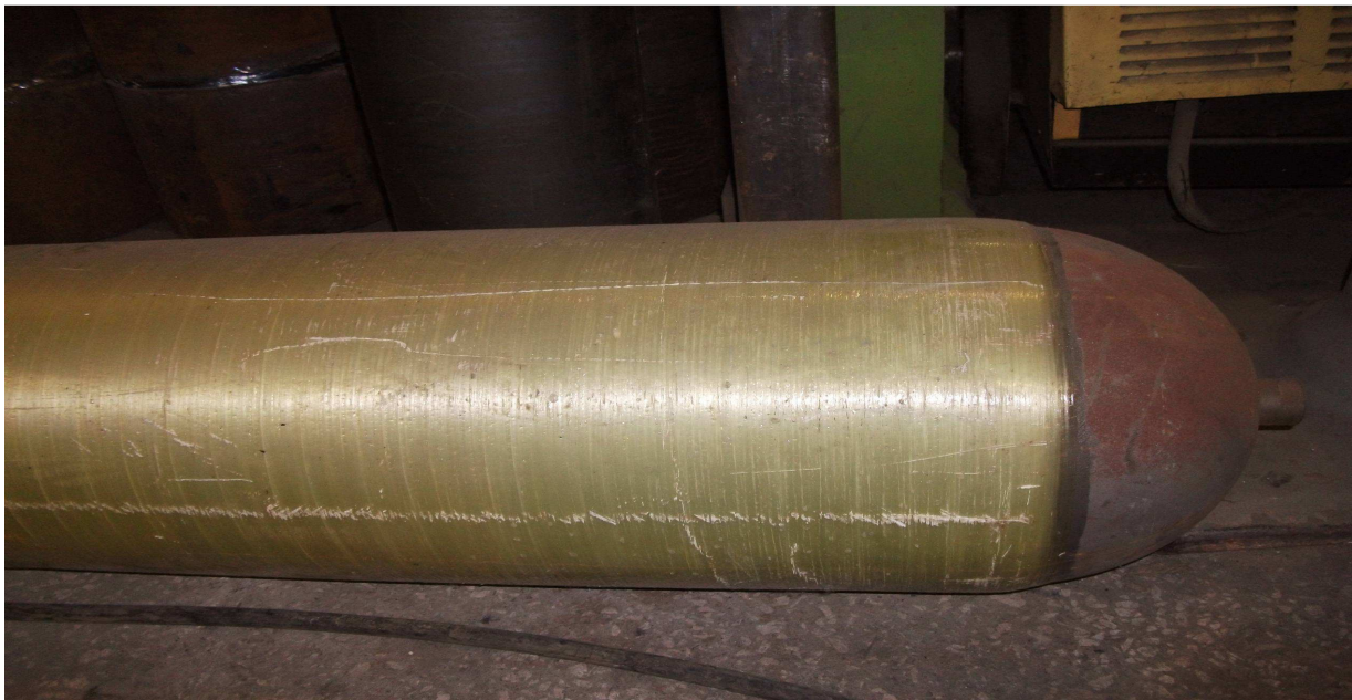
Рисунок 1 – Комбінований балон – сталевий лейнер з оболонкою із композиційного матеріалу
