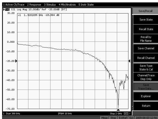
Рис. 10. Експериментальна залежність параметра S_{21} кабелю UTP5e, розміщеного в слабопровідному ґрунті, після впливу МЭМИ
