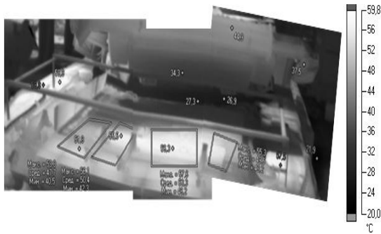
Рис. 7. Термограма кормової частини танка після прогрівання двигуна та на яку падає сонячне випромінювання
