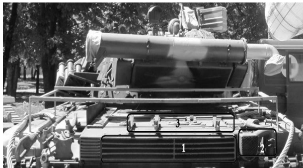
Рис. 8. Розподіл підвищеної температури елементів танка за ділянками під час дослідження: 1 – 90 \pm 5 \text{ }^\circ\text{C} ; 2 – 120 \pm 10 \text{ }^\circ\text{C} ; 3 – 60 \pm 5 \text{ }^\circ\text{C}
