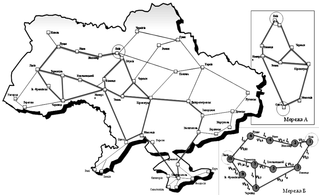
Рис. 1. Варіант загальної схеми державної цифрової мережі зв'язку України та виділені мережі між штабами (варіант мереж: А – зв'язок Київ-Одеса; Б – зв'язок Київ-Львів)
