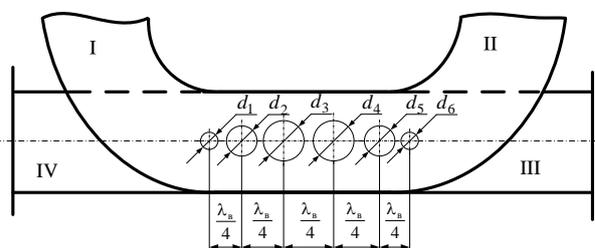
Рис. 1. Схематическое изображение многодырочного комбинированного направленного ответвителя
