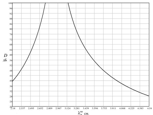
Рис. 2. Зависимость направленности направленного ответвителя от частоты
