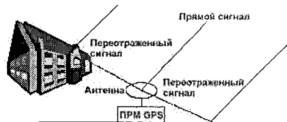
Рис. 1. Принцип формирования переотраженного сигнала
