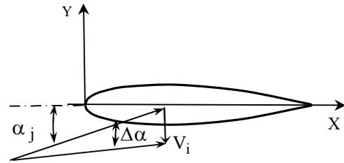
Рис. 4. Коррекция угла атаки за счет индуктивной скорости
