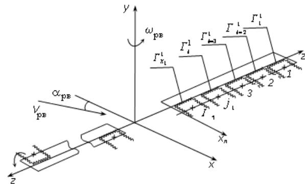
Рис. 5. Расположение вихрей на лопастях винта
