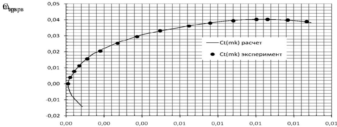
Рис. 6. Поляра рулевого винта при  $\omega_{рв} R_{рв} = 204$  м/с
