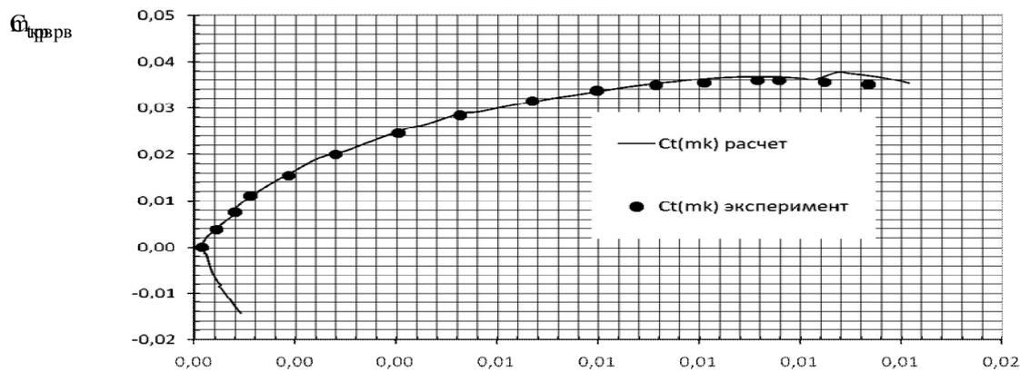
Рис. 8. Поляра рулевого винта при  $\omega_{pv} R_{pv} = 254$  м/с
