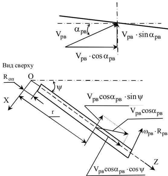
Рис. 1. Составляющие скорости на поверхности лопасти рулевого винта
