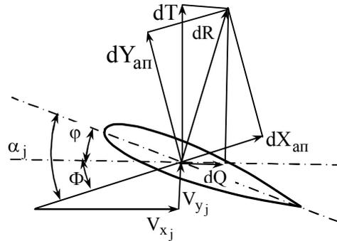
Рис. 2. Схема сил на профиле лопасти винта
