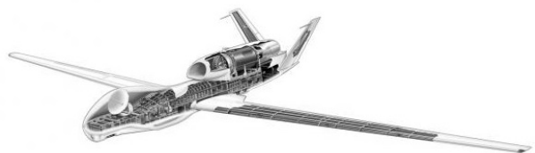
Рис. 1. Компоновочная схема БПЛА RQ-4B
