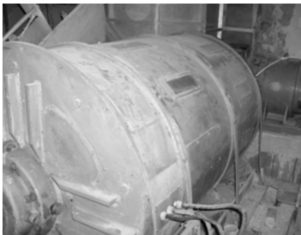
Рис. 9. Фотография внешнего вида электродвигателя основного эксгаустера сверхзвуковой аэродинамической трубы СЗТ
