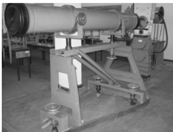
Рис. 11. Схема модернізованої сверхзвукової аеродинамічної труби СЗТ
