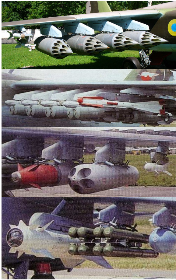
Рис. 1. Варіанти загрузки АЗУ на штурмовик Су-25
