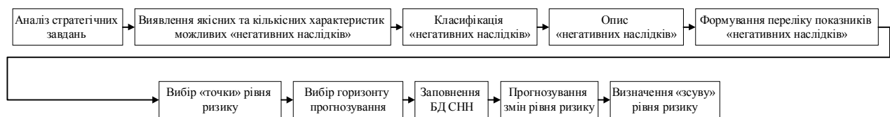
Рис. 9. Послідовність дій для автоматизованого формування сценаріїв визначення динаміки зміни рівня ризику від введення в дію конкретних стратегічних завдань
