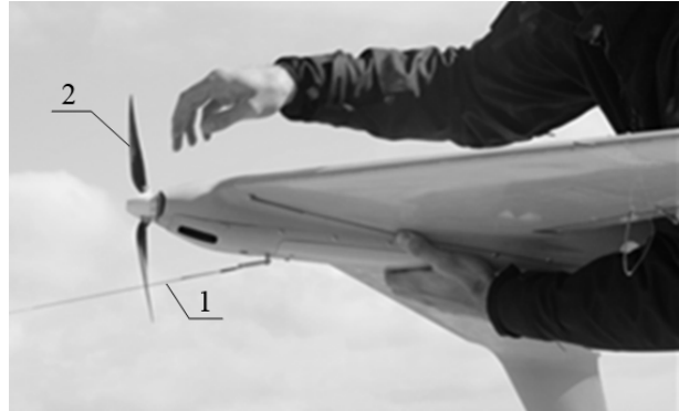
Рис. 3. Кріплення пришвидшувача до БпЛА: 1 – стропа пришвидшувача; 2 – лопать гвинта
