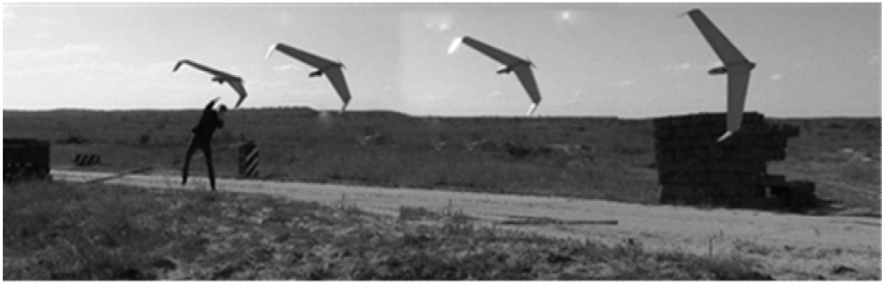
Рис. 5. Невдалий зліт БпЛА внаслідок відмови сервомеханізму відхилення елевону
