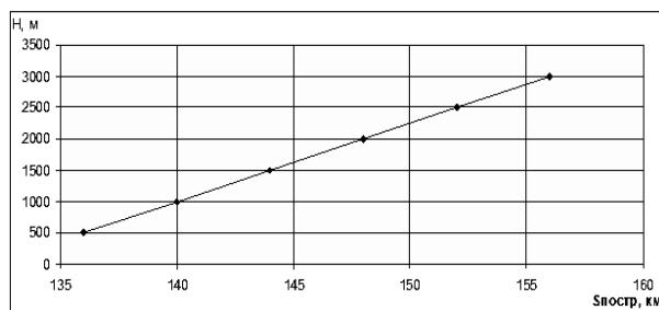
Рис. 5. Залежність довжини ділянки шикування від висоти шикування бойового порядку літаків
