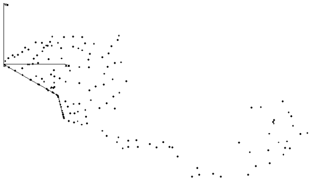
Рис. 4. Вихревая схема профиля с механизацией и вихревых пелен
