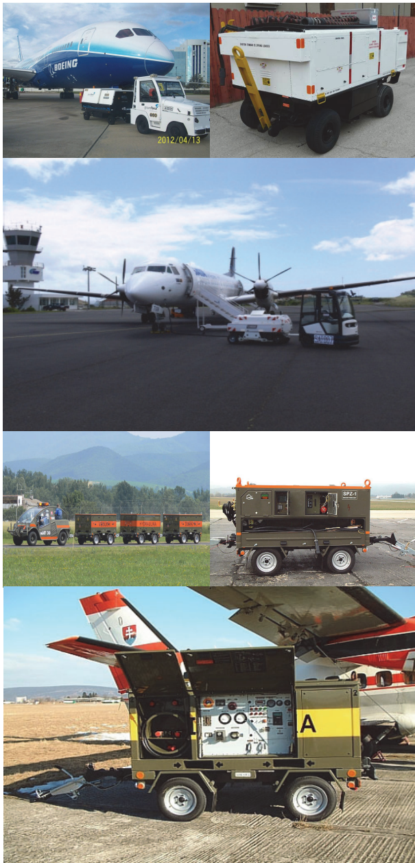
Рис. 4. Приклади багатоланкових модульних аеродромних машин
