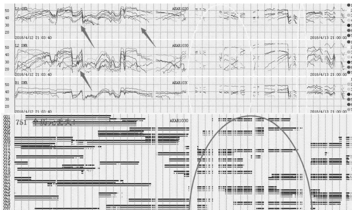
Рис. 8. Епюри стеження-накопичення сигналу від супутникового угруповання
