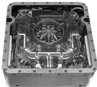
Рис. 4. Лазерний гіроскоп КП СПС «Арсенал» та його технічні характеристики
