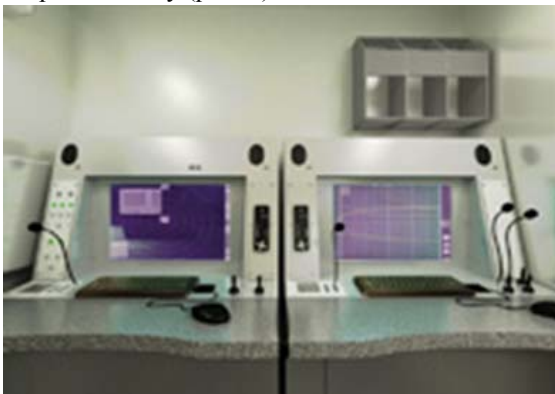
Рис. 2. Зовнішній вигляд робочого місця оператора оглядового радіолокатора і оператора посадочного радіолокатора
