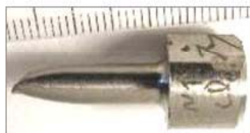
Рис. 1. Влияние способа введения кислорода на характер разрушения образцов титана типа ВТ1-0:
