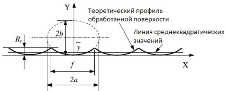
Рис. 3. Теоретический профиль поверхности, состоящий из эллиптических дуг [3]
