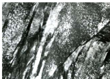
Рис. 4. Структура закаленной стали после отпуска 200 °С \times 18000
