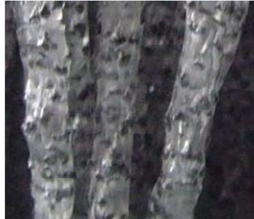
Рис. 1. Волокна полимерно-абразивного инструмента
