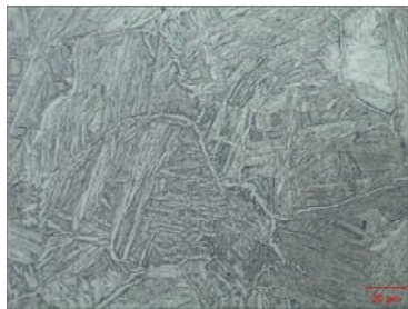
Рис. 6. Микроструктура отдельного наплавленного слоя:
