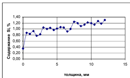
Рис. 3. Распределение легирующих элементов по толщине трехслойной наплавки стали 20X12Г9СТАФ: а – хром; б – марганец; в – кремний
