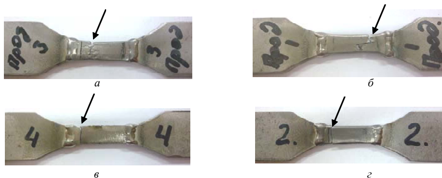
Рис. 3. Внешний вид образцов после разрушения:
