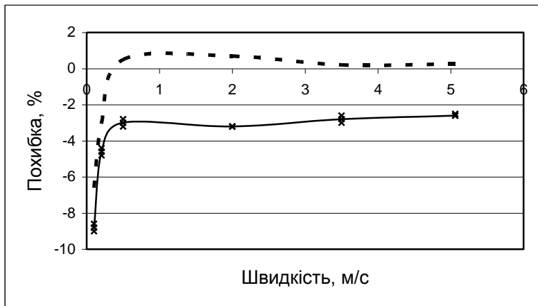
Рис.7. Порівняння поведінки похибок витратоміра 2 в діапазоні швидкостей на трубах діаметрами 100 і 200 мм
