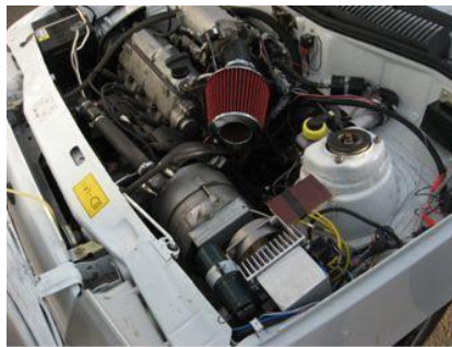
Рис. 3. Розташування гібридної силової установки на автомобілі ЗА3-110550
