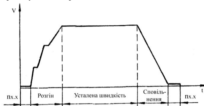
Рис. 1. Спрощений їздовий цикл тракторного поїзда
