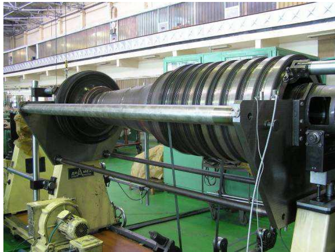
Рис. 1 Загальний вид ротора на балансувальному стенді зі сторони випробувального підшипника. Видно акселерометри на люльці стенда
