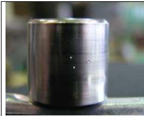
Діаметр проколювання 0,3-0,5 мм Глибина 0,064 мм Вивертання матеріалу з країв проколу 0,006 мм Одиночний прокол розміщений при куті 215° по кулястості відносно зони трьох проколів
