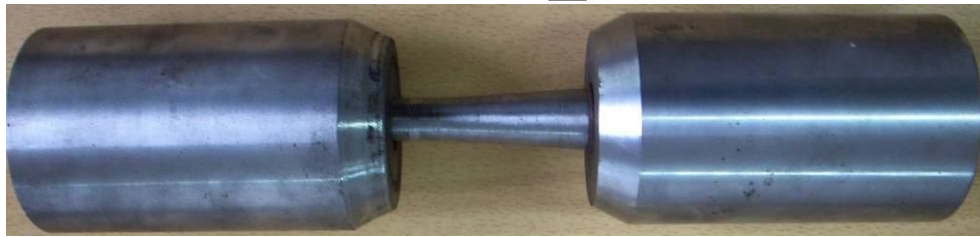
Рис.2. Прес-форма для пресування спроектована в SolidWorks та її загальний вигляд. 1,6 - запірні циліндри; 2 - кришка; 3 - оболонка; 4 - порошок; 5 - оправка
