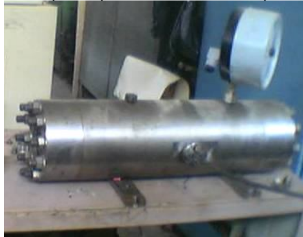
Рис. 3. Прес-блок експериментальної установки для сухого радіально-ізостатичного пресування
