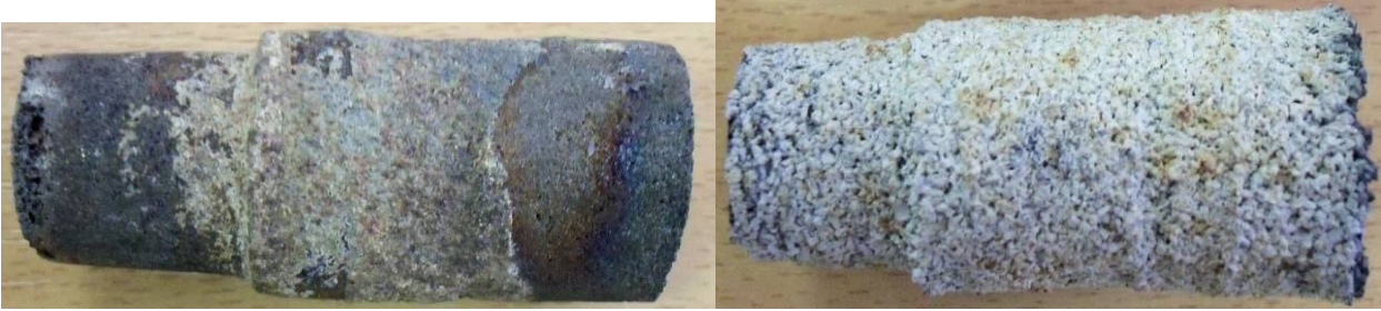
Рис. 5. Спресовані та спечені (в режимі СВС) сопла простої форми для пікоструменевої обробки.
